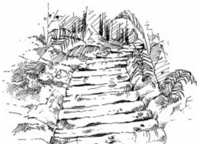
Figura N°6. Superficie de troncos para atravesar superficies mojada.
